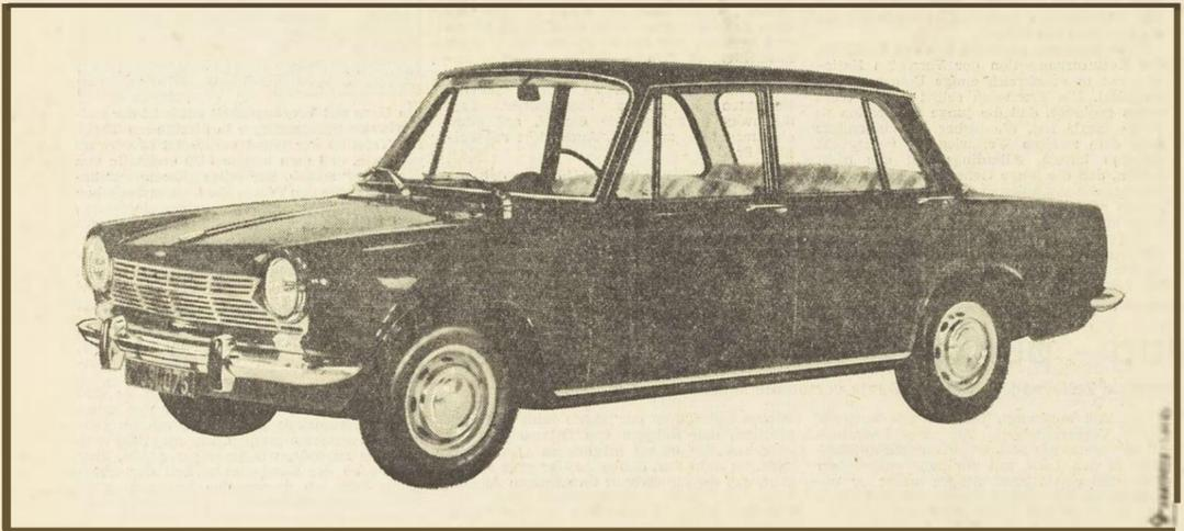
**MOTOR.** 4 Zyl. - 1300 cc - mehr als 130 km/h - 8 Steuer-PS - 62 Brems-PS - fünfmal gelagerte Kurbelwelle. Der motor ist wirklich derjenige würdig, die SIMCA seine Weltrekorde in Monthéry und Miramas verschafften.
